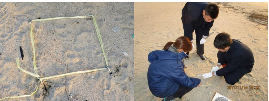
マイクロプラスチック調査方法は（NEAR方式：20cm角、深さ2.5cm）砂を採取しふるいにかけて個数を数える
