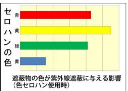
図7 色セロハンの紫外線防止効果
